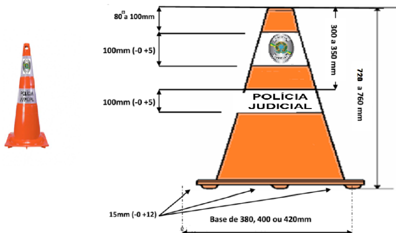
Figura 1: Especificações de algumas dimensões do cone - lado dianteiro
